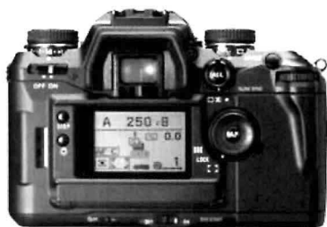
La Minolta Dynax 7 permette la visualizzazione degli istogrammi di esposizione sul monitor posto sul retro
